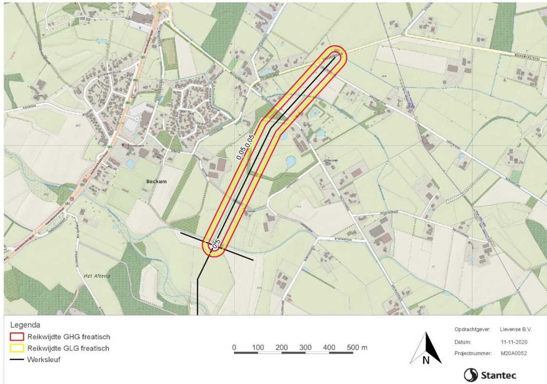
Figuur 5: Theoretisch invloedsged (verlagingscontour 0,05 meter en 0,5 meter) bij bemaling onder GHG (rode lijnen) en GLG (gele lijnen)
