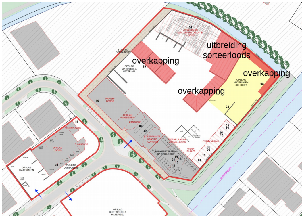
f1.9 Inrichtingsvariant B (gelijk aan A plus luifel 15 m bij opslag metalen/schroot)
