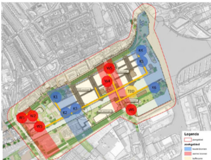
Afbeelding 2.10: Schematische weergave warmte- en koudebronnen (bron: scenariostudie energie RHDHV)
