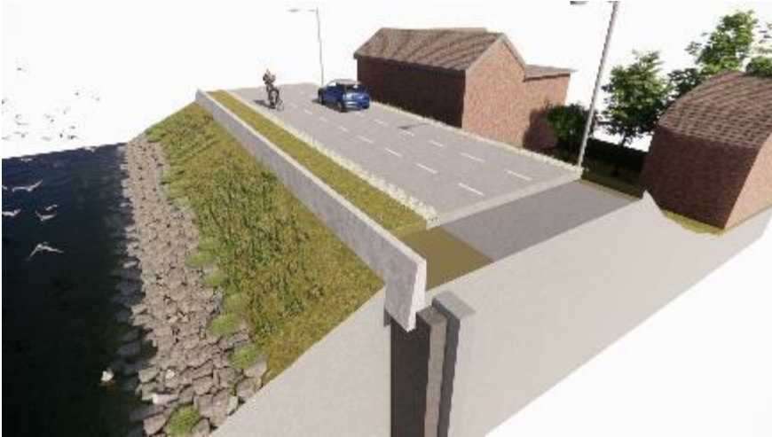
Figuur 3.2: Een zelfstandig kerende constructie wordt ook wel een Type I versterking genoemd.
