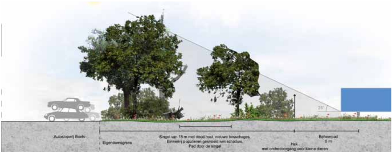
Afbelding 27. Dwarsprofiel A-A' inpassing van de rand langs de autosloperij
