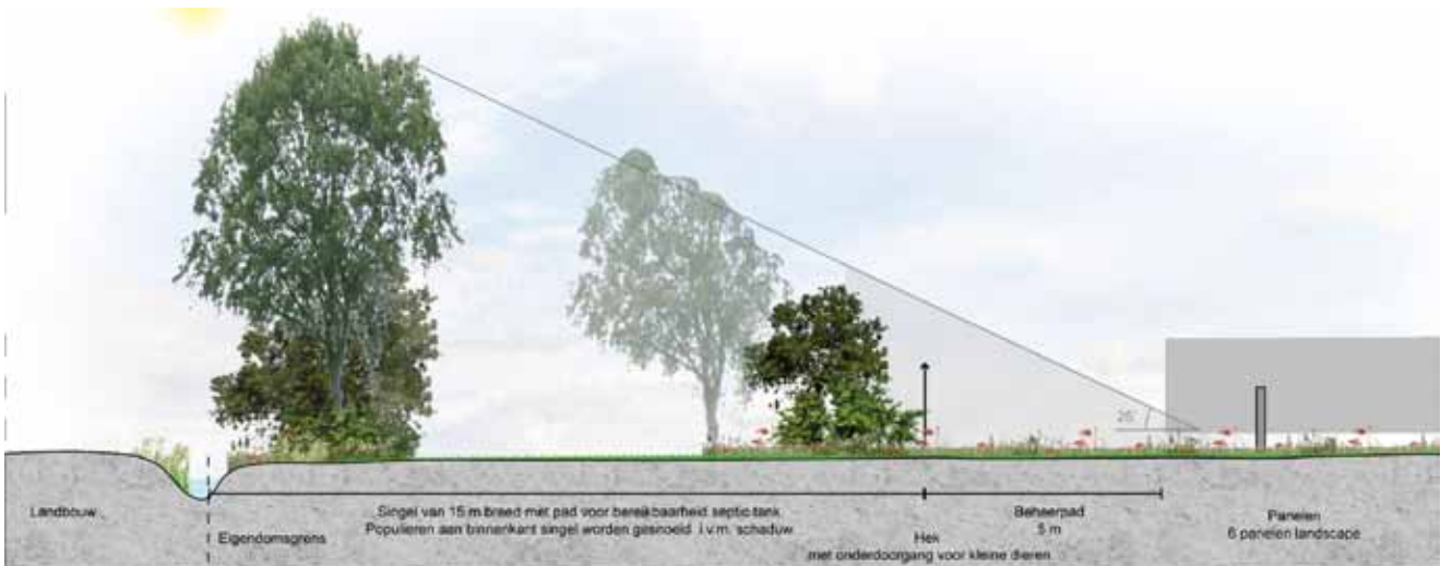
Afbelding 26. Dwarsprofiel C-C' inpassing van een deel van de rand inclusief behoud enkele populieren tbv vliegroute voor vleermuizen.
