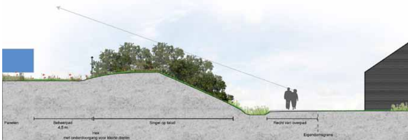
Afbeelding 31. Dwarsprofiel F-F' inpassing van de oostkant van het westelijke perceel
