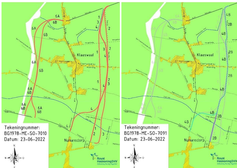
Figuur 5-21: Bodemkwaliteit ondergrond 0,5-2 m-mv met alternatieven (links: 80 km/h / rechts: 60 km/h)
