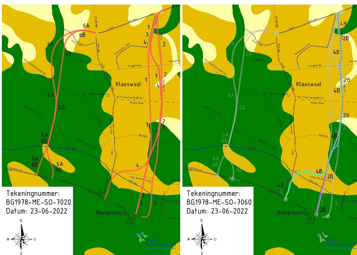
Figuur 5-23: Kaart stabiele bodem (zettingsgevoeligheid) met alternatieven (links: 80 km/h / rechts: 60 km/h)
