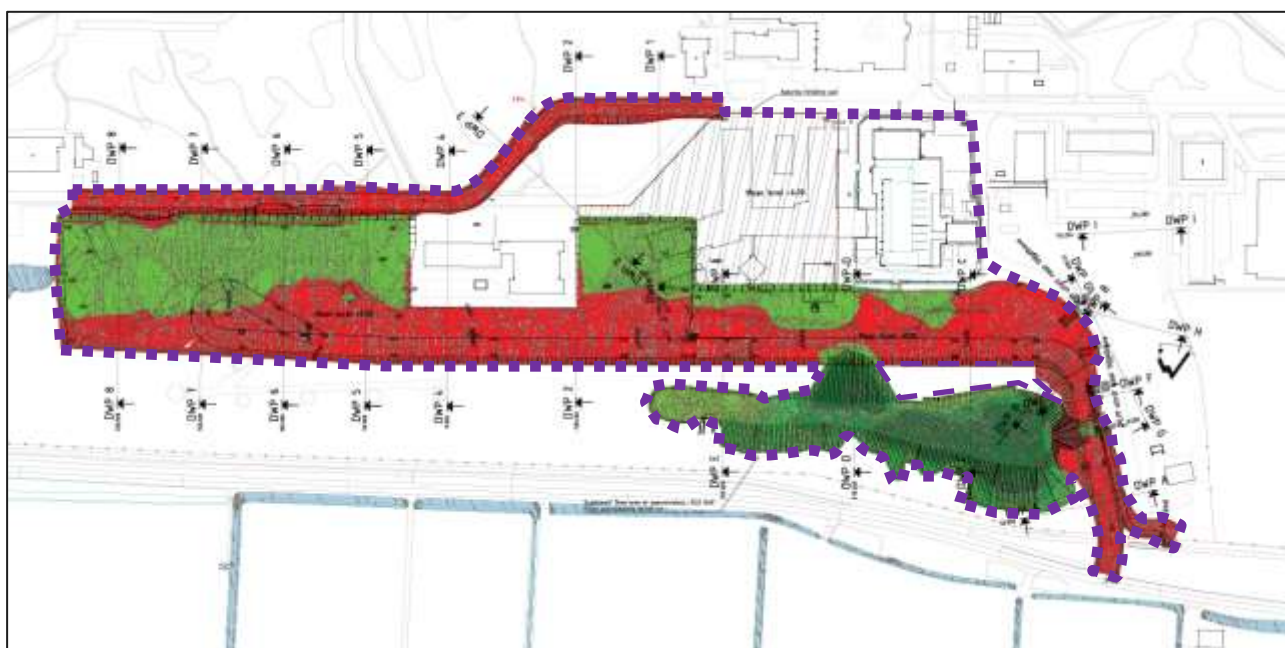
Figuur 2-8 Verplaatsing van zand in het projectgebied (grondstromenplan). Rood geeft aan waar zand wordt afgegraven, groen waar zand wordt aangebracht. De onderbroken, paarse lijn geeft aan waar grondverzet mogelijk is.
