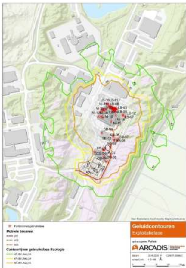
Figuur 4-7: Geluidscontouren in de exploitatiefase.
