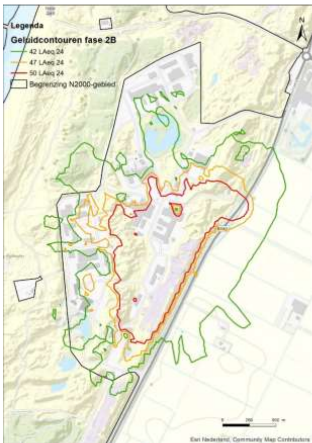
Figuur 4-6: Geluidscontouren voor het aanbrengen van compressielaag.
