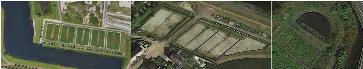
Figuur 11-6. Voorbeelden ijzerzandfilters (Bron: Google Earth). Links: Waterakker Breda Waterzuivering (Teteringen). Midden: Zandfilter Blaricummeent (Blaricum). Rechts: Knooppunt A1 en Hilversumseweg: zuivering wegwater en infiltratie (Laren).
