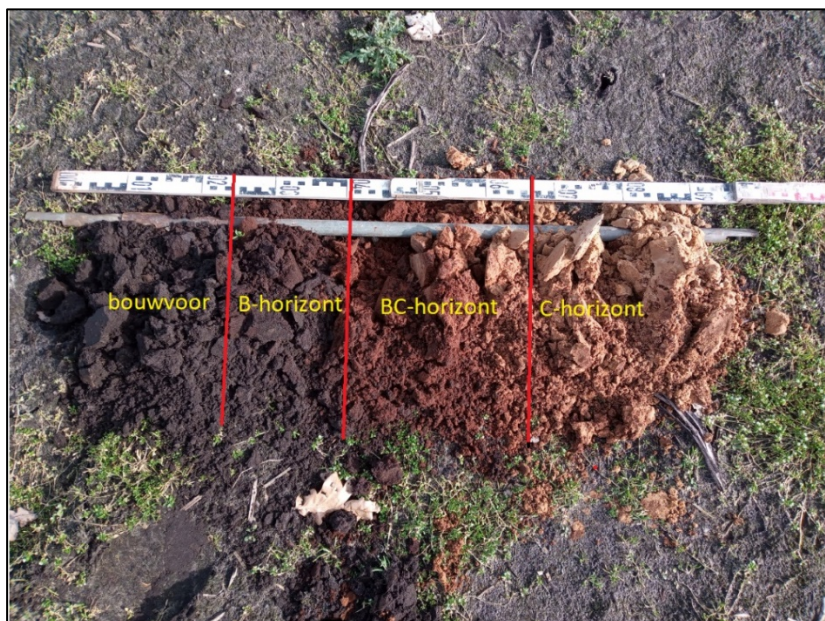
Afbeelding 16. Boorkern van boring 76 met interpretatie
