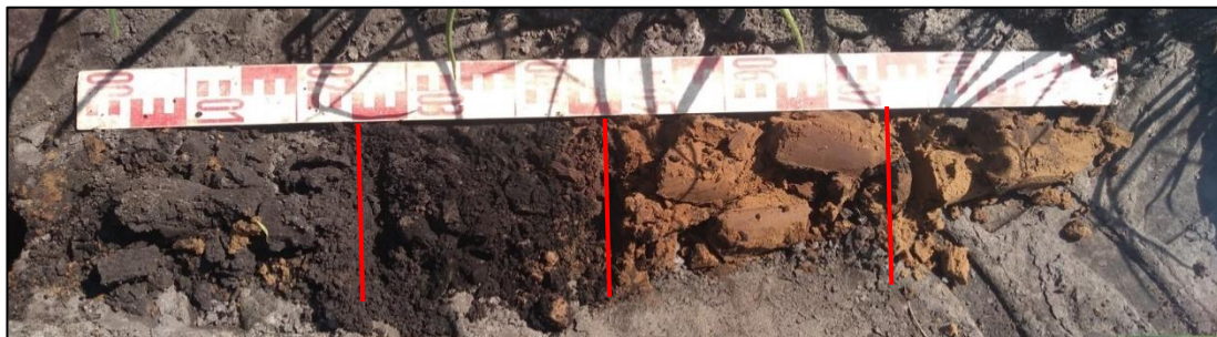
Afbeelding 16: Foto van de boorkern van boring 37 met van links naar rechts de grijsbruine bouwvoor, een laagje zwart veraard veen, de orangerode intacte podzol B (zwak ontwikkeld) en vervolgens lichtgeel dekzand.
