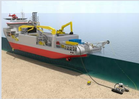
Afbeelding 4-5: Voorbeeld van een Tracked Remotely Operated Vehicle op zee
