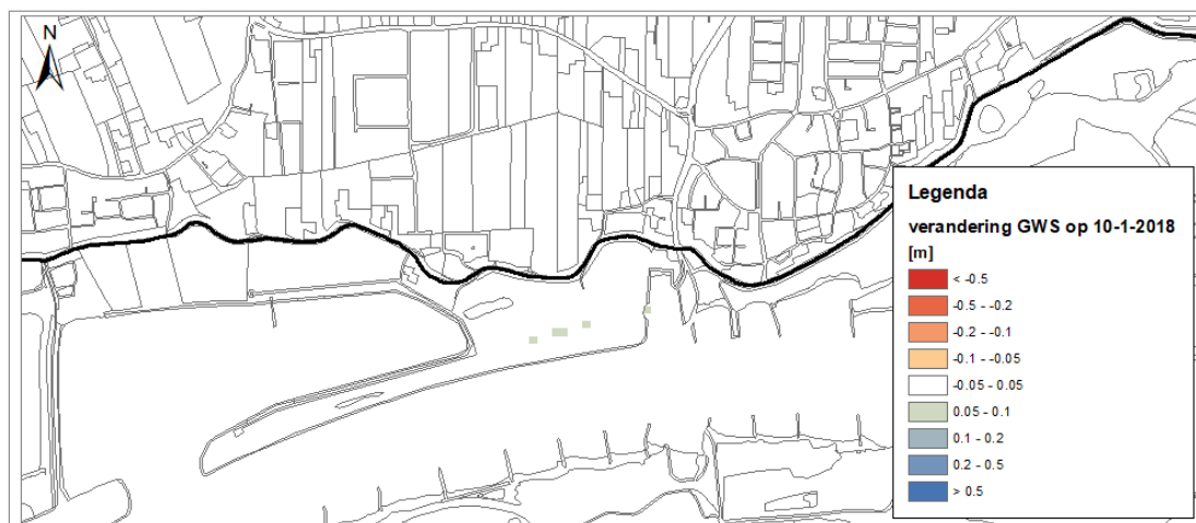
Figuur 5-3: Berekende effecten op de grondwaterstand voor variant 1.
