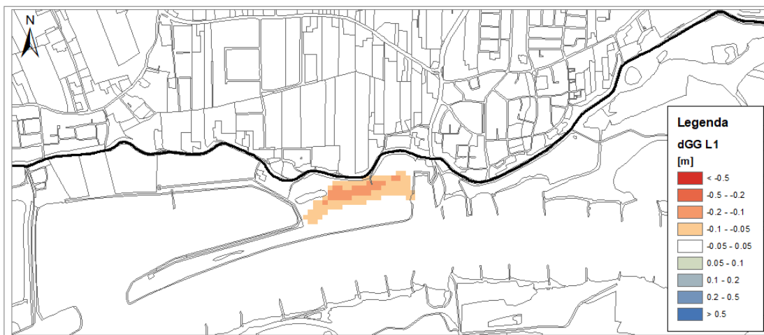
Figuur 5-14: Berekende effecten op de grondwaterstand voor variant 2.
