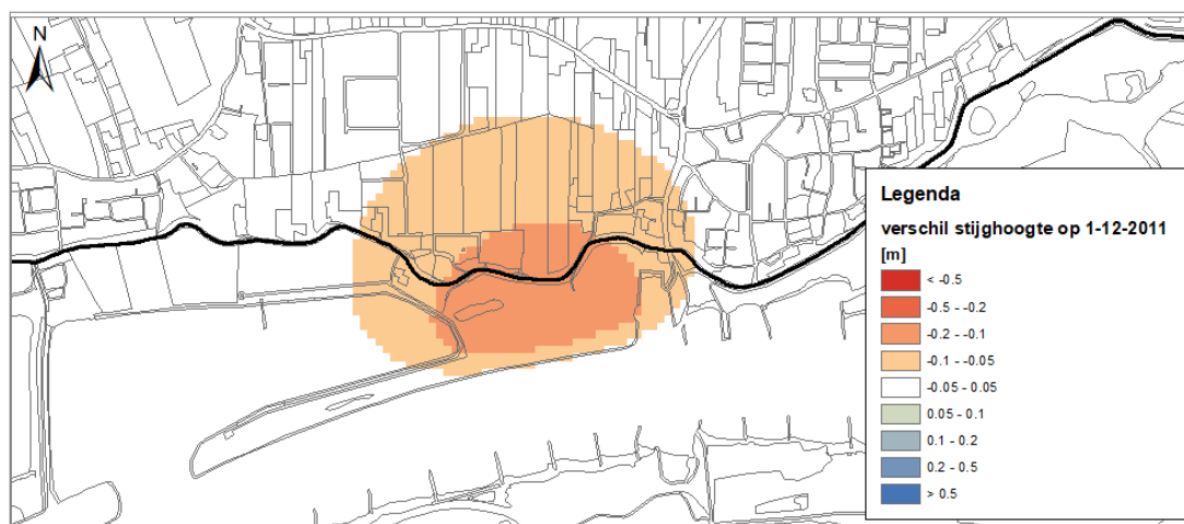
Figuur 5-7: Berekende effecten op de stijghoogte voor variant 1.
