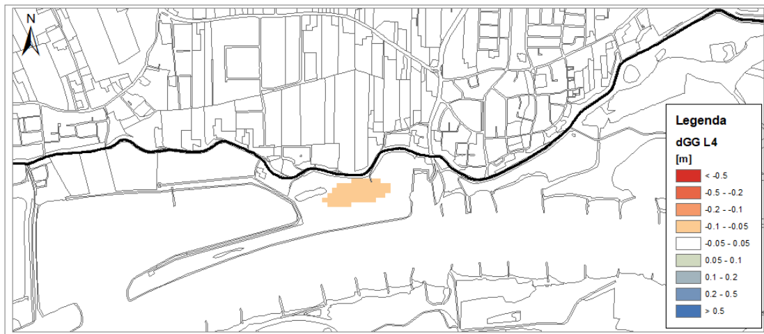
Figuur 5-11: Berekende effecten op de stijghoogte voor variant 1.
