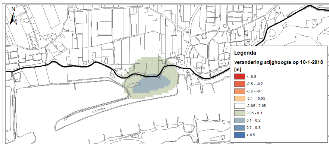
Figuur 5-1: Berekende effecten op de stijghoogte voor variant 1.
