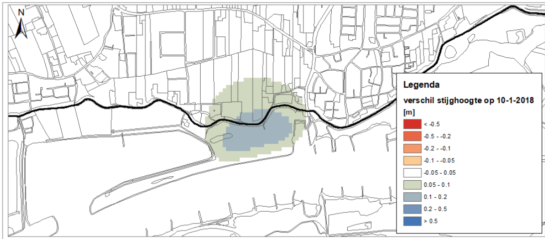
Figuur 5-2: Berekende effecten op de stijghoogte voor variant 2.
