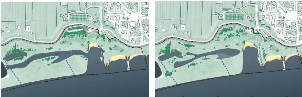
Figuur 6-14 Ontwerpvarianten van de geul (links variant 1, rechts variant 2) en ligging kribben met potentieel archeologische waarde (blauwe stippellijn).
