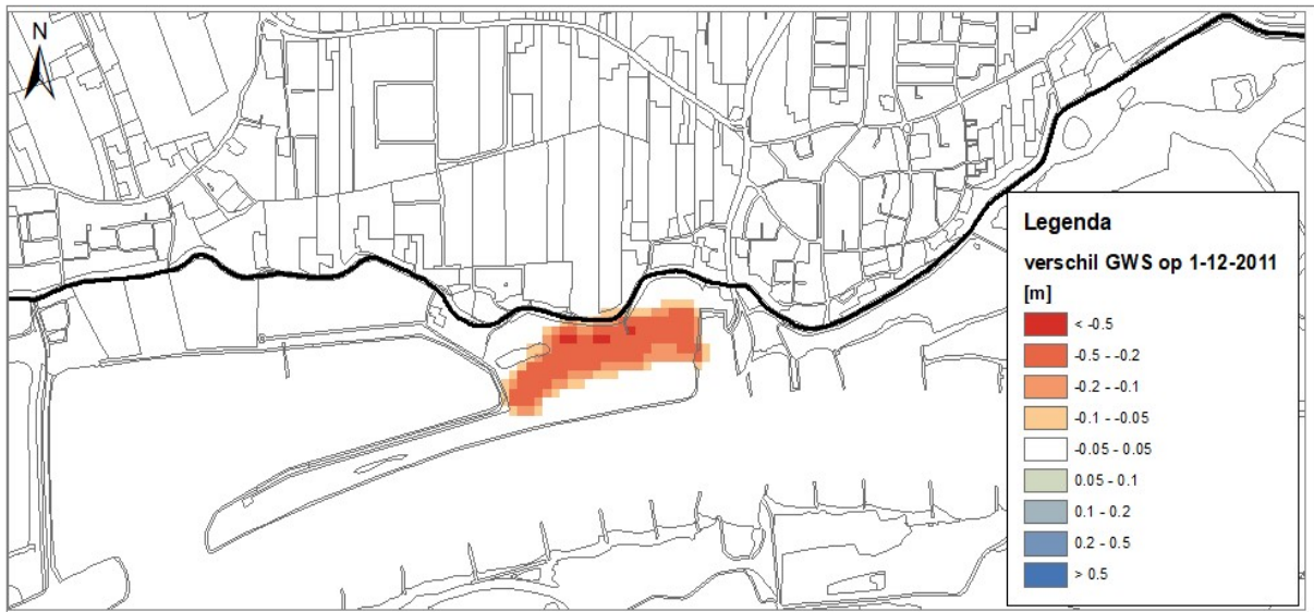
Figuur 6-27: Berekende effecten op de grondwaterstand voor variant 2 bij laagwater T10 (herhalingsijd 10 jaar).
