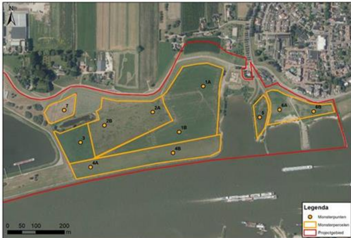
Figuur 7-6 Op de percelen 1, 2, 3 en 6 diep ploegen (50 cm), op de percelen 4, 5 en 7 frezen van de grasmat
