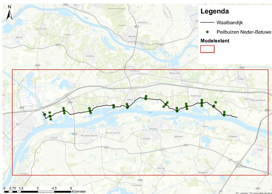
Figuur 2: Dijktraject van het Neder-Betuwe dijkversterkingsproject, alle peilbuizen in het eerste watervoerend pakket en de extent van het grondwatermodel.
