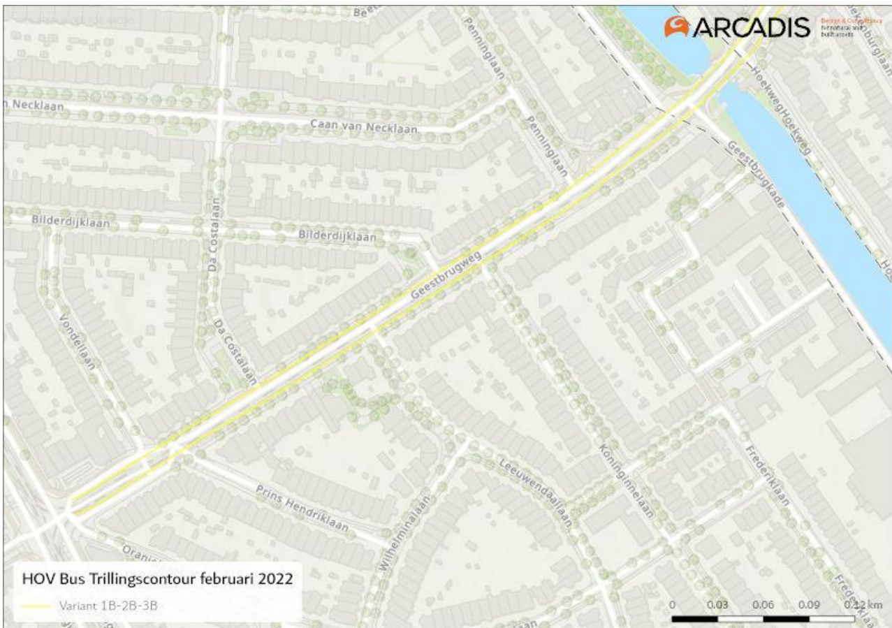
Figuur 4-16 Contourlijnen trillingshinder HOV bus deeltekening 12; de panden binnen de contouren zijn rood gearceerd.
