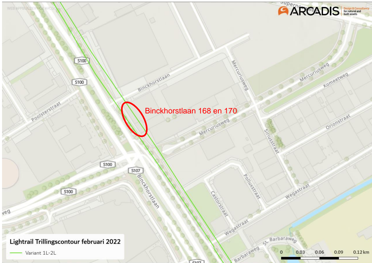
Figuur 4-32 Contourlijnen trillingshinder lightrail deeltekening 3; de panden binnen de contouren zijn rood gearceerd.
