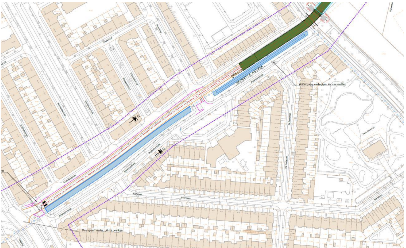
Figuur 2-58 Inpassing van een HOV-baan aan één zijde van de groenzone Broekslootkade (variant 5B)
