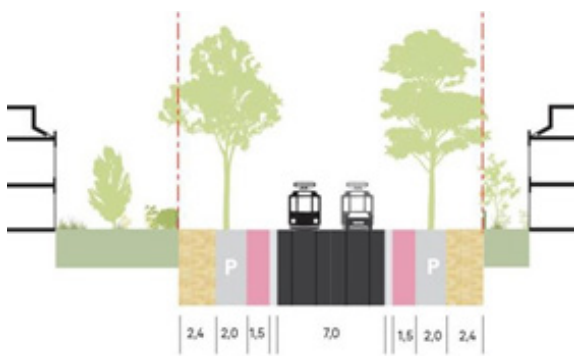
Figuur 46: Dwarsprofiel Prinses Mariannelaan voor tram
