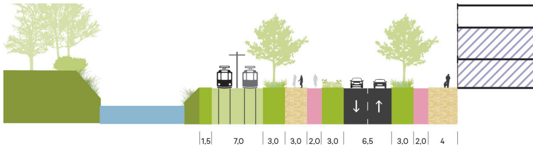
Figuur 37: Dwarsprofiel Zonweg voor HOV-tram
