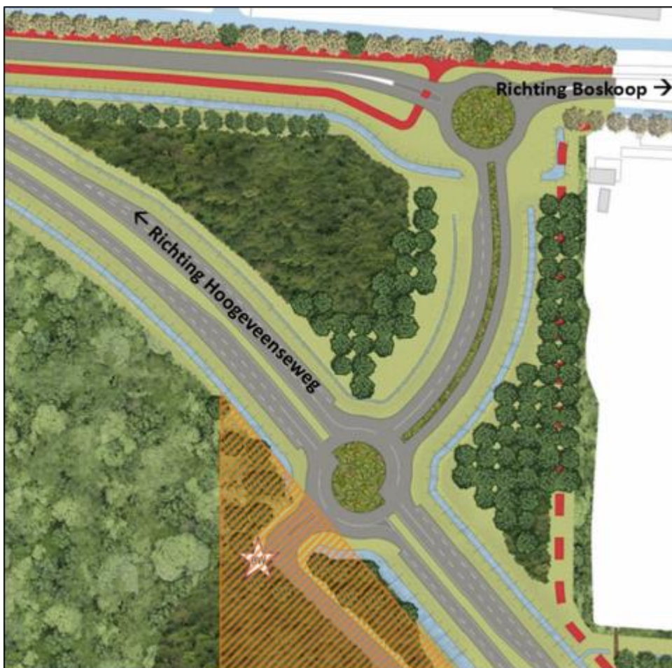
Figuur 3.10 Locatie van de turborotonde in de Verlengde Bentwoudlaan en enkelstrookstrotonde in de Hoogeveenseweg (bron: MER)
