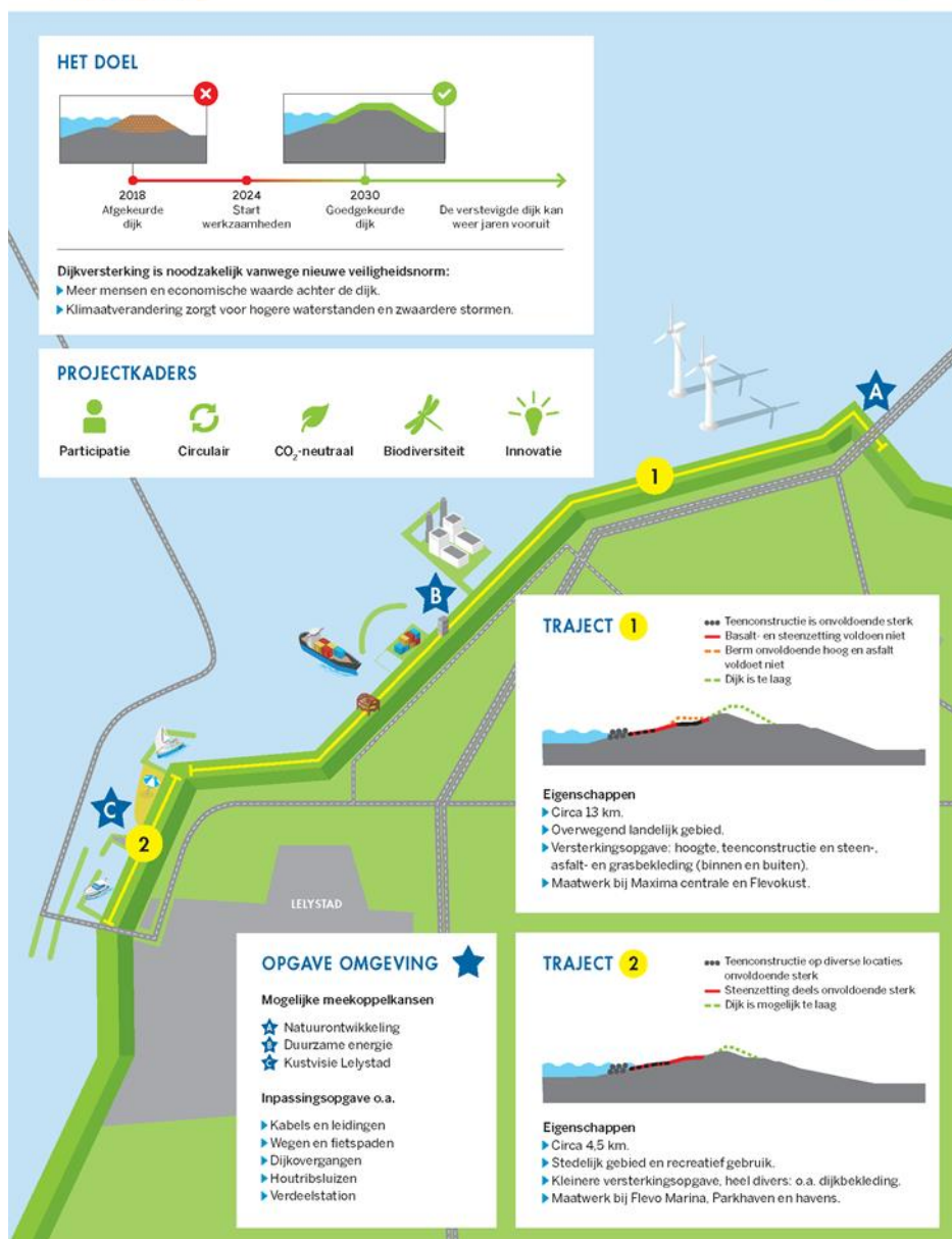
Figuur i: Schematische weergave van de projectopgave voor de versterking van de IJsselmeerdijk
