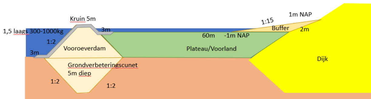
Figuur 1: Vooroevergeometrie dijkvak 1 en 2
