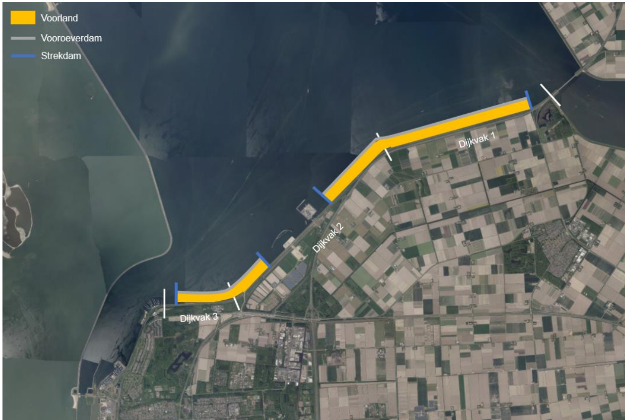
Figuur 3-18: Schematische weergave van de locatie van strekdammen (ruimtebeslag niet op schaal).
