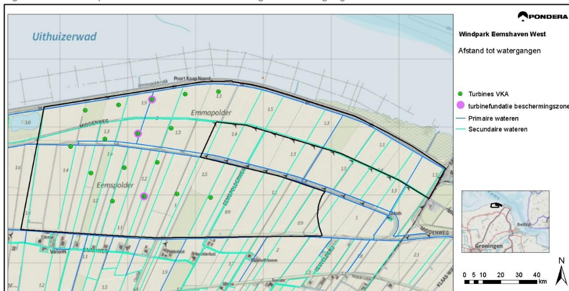
Figuur 15.13 Overlap turbinefundatie met beschermingszone watergangen
