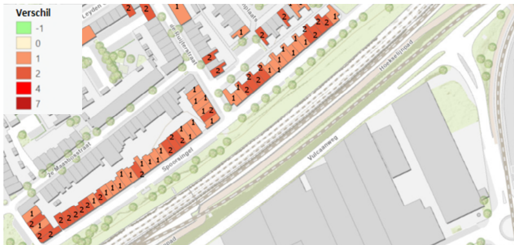
Figuur 4.9: Verschillen in de buurt van de Vulcaanweg ten gevolge van wegverkeer (inclusief verkeersvariant 1) voor de situatie met gebouwen ter plaatse van de ontwikkelvelden. In dit figuur zijn alleen de woningen met een geluidbelasting van boven de 50 dB excl. aftrek ex artikel 110g Wet geluidhinder weergegeven. (bron onderlegger ESRI)
