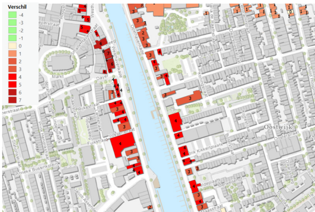
Figuur 4.13: Verschillen ter plaatse van de Westhavenkade en Oosthavenkade ten gevolge van wegverkeer (inclusief verkeersvariant 2) voor de situatie met gebouwen ter plaatse van de ontwikkelvelden. In dit figuur zijn alleen de woningen met een geluidbelasting van boven de 50 dB excl. aftrek ex artikel 110g Wet geluidhinder weergegeven. (bron onderlegger ESRI)
