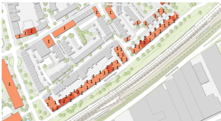
Figuur 4.3: Verschillen in de buurt van de Vulcaanweg ten gevolge van wegverkeer voor de situatie met gebouwen ter plaatse van de ontwikkelvelden. In dit figuur zijn alleen de woningen met een geluidbelasting van boven de 50 dB excl. aftrek ex artikel 110g Wet geluidhinder weergegeven. (bron onderlegger ESRI)
