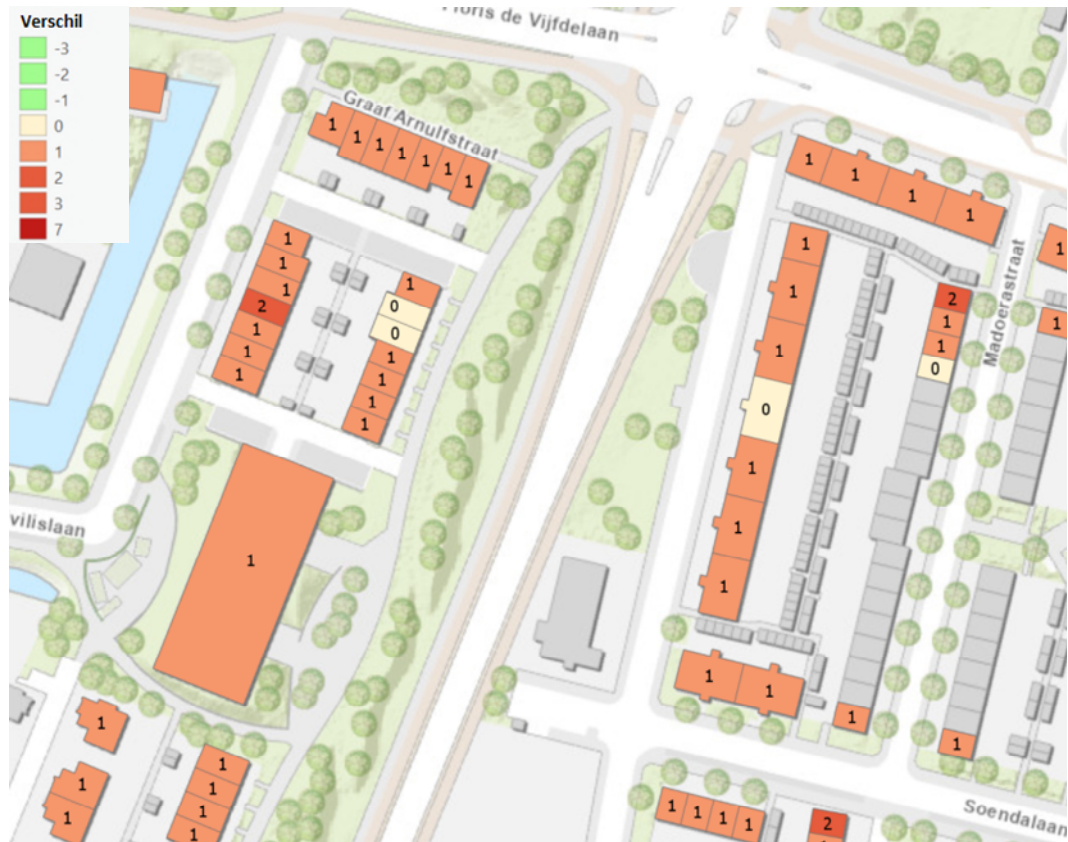
Figuur 4.20: Verschillen ter plaatse van de Marathonweg ten gevolge van wegverkeer (inclusief verkeersvariant 2A) voor de situatie met gebouwen ter plaatse van de ontwikkelvelden. In dit figuur zijn alleen de woningen met een geluidbelasting van boven de 50 dB excl. aftrek ex artikel 110g Wet geluidhinder weergegeven. (bron onderlegger ESRI)
