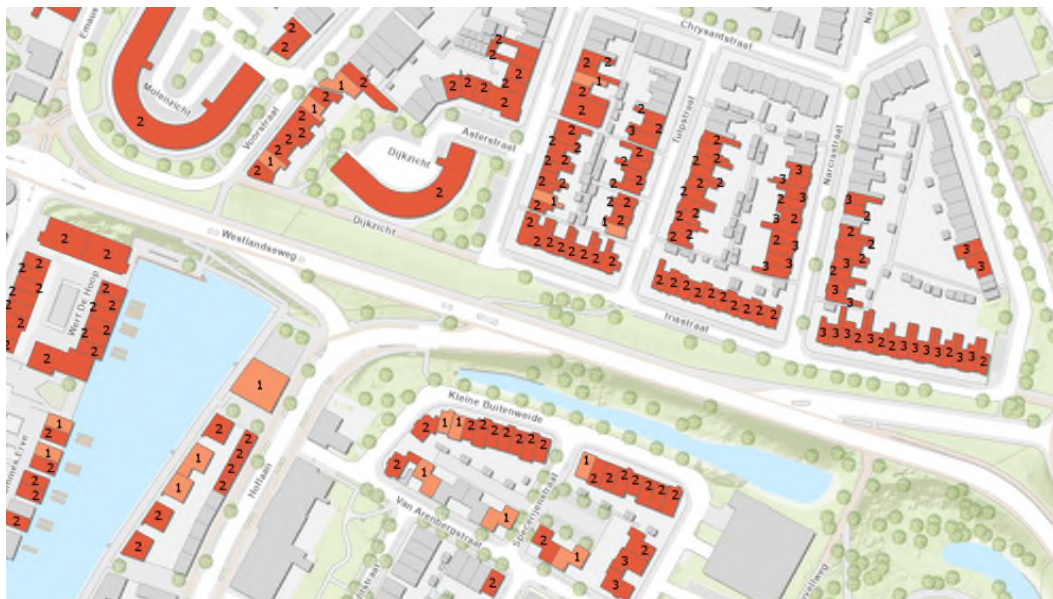
Figuur 4.14: Verschillen in de buurt van de Westlandseweg ten gevolge van wegverkeer (inclusief verkeersvariant 2) voor de situatie met gebouwen ter plaatse van de ontwikkelvelden. In dit figuur zijn alleen de woningen met een geluidbelasting van boven de 50 dB excl. aftrek ex artikel 110g Wet geluidhinder weergegeven. (bron onderlegger ESRI)
