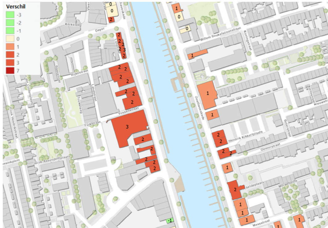
Figuur 4.19: Verschillen ter plaatse van de Westhavenkade en Oosthavenkade ten gevolge van wegverkeer (inclusief verkeersvariant 2A) voor de situatie met gebouwen ter plaatse van de ontwikkelvelden. In dit figuur zijn alleen de woningen met een geluidbelasting van boven de 50 dB excl. aftrek ex artikel 110g Wet geluidhinder weergegeven. (bron onderlegger ESRI)
