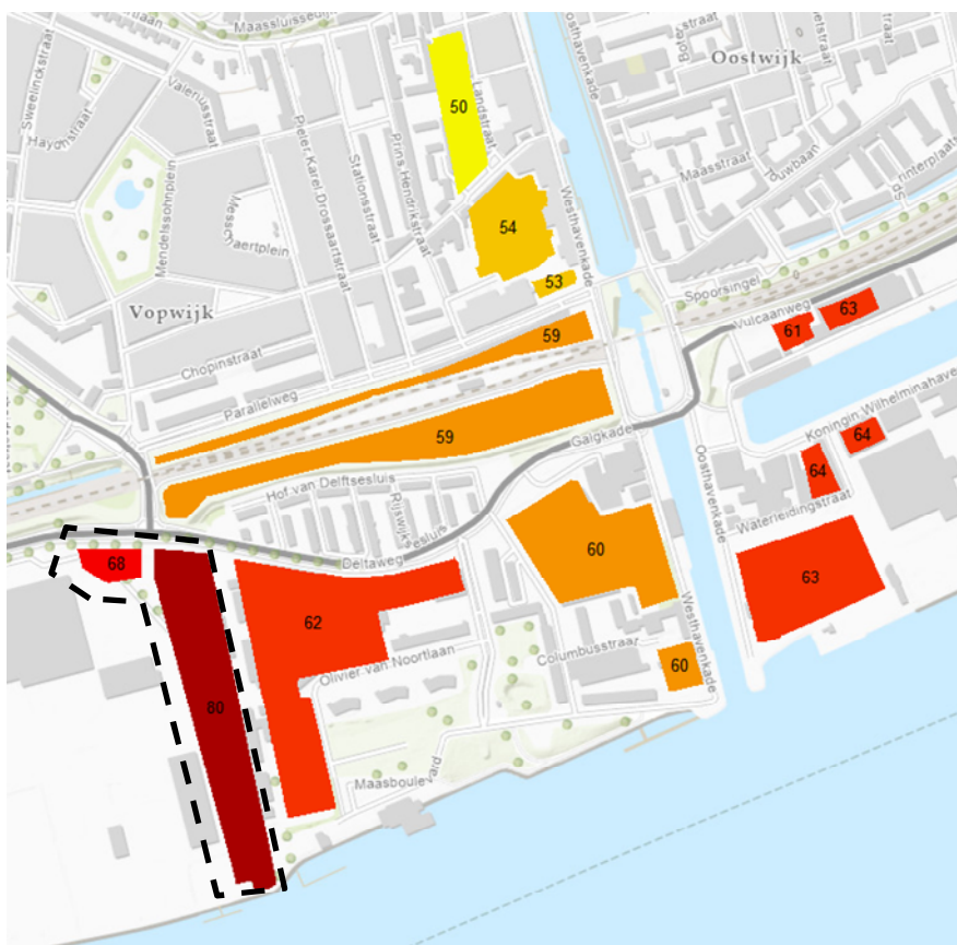
Figuur 3.1: De geluidbelastingen met betrekking tot Industrielawaai ter plaatse van de ontwikkelvelden voor de situatie zonder gebouwen ter plaatse van de ontwikkelvelden. (bron onderlegger ESRI)
