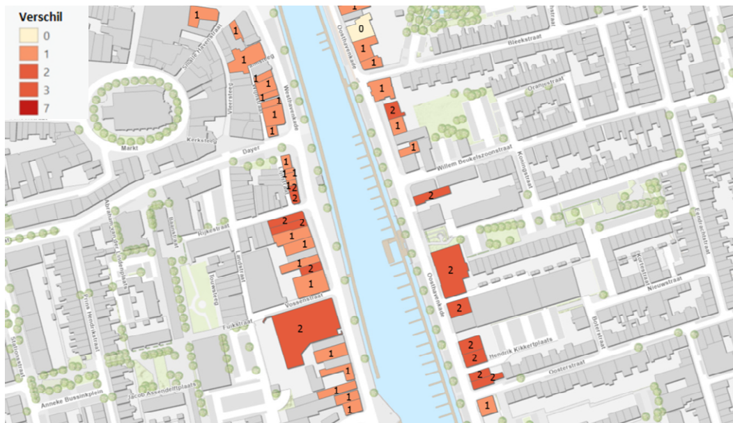
Figuur 4.2: Verschillen ter plaatse van de Westhavenkade en Oosthavenkade ten gevolge van wegverkeer voor de situatie met gebouwen ter plaatse van de ontwikkelvelden. In dit figuur zijn alleen de woningen met een geluidbelasting van boven de 50 dB excl. aftrek ex artikel 110g Wet geluidhinder weergegeven. (bron onderlegger ESRI)
