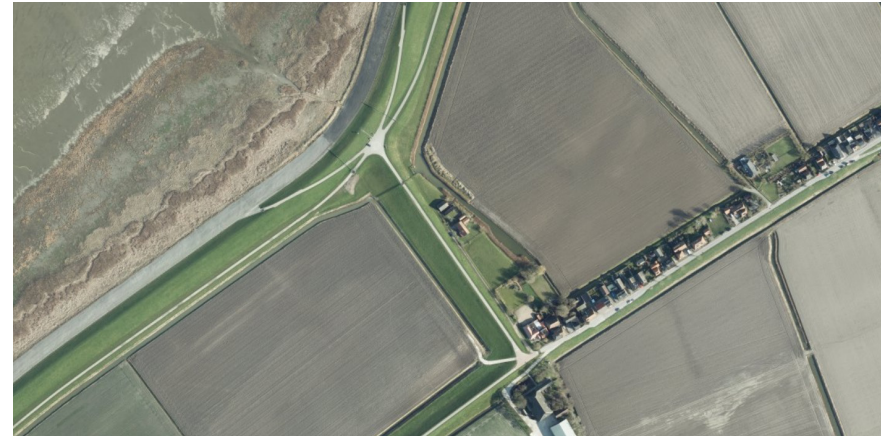
Afbeelding 3.2 Een oude dijk bij Westhoek takt aan op de huidige zeedijk. Dit is het meest westelijke deel van de Nieuwe Bildtdijk die hier aansluit op de Oude Bildtdijk.
