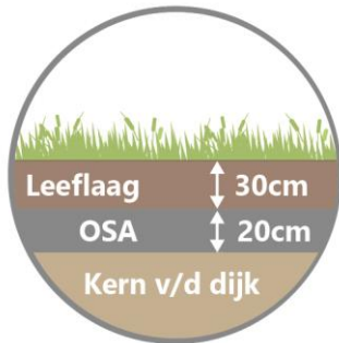
Afbeelding 3.2 Schematische weergave open steenasfalt (OSA)
