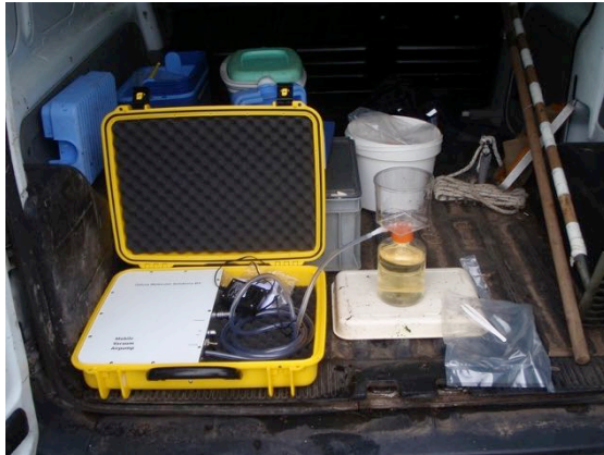
Figuur 8 Mobiele filtratieopstelling ten behoeve van bemonstering eDNA achterin laadruimte van auto. Foto A. Kersbergen.
