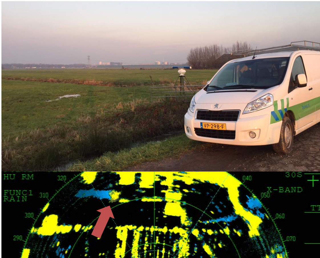
Figuur 7 Boven: Opstelling radar (Furuno 25 kW) langs de Ringkade voor onderzoek aan slaaptrek van watervogels. Onder: uitsnede van het radarbeeld tijdens het eerste veldbezoek. De pijl wijst naar de vliegbeweging van een groep Kieviten richting oost tussen Heycopperkade en de Middelwatering (op het scherm zichtbaar als gele stip met blauwe 'staart'). Foto: H. Prinsen.
