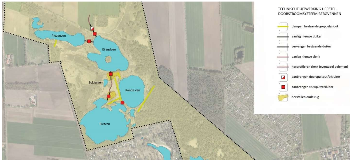
Figuur 4.11 technische uitwerking herstel doorstroomstelsel Bergvennen
