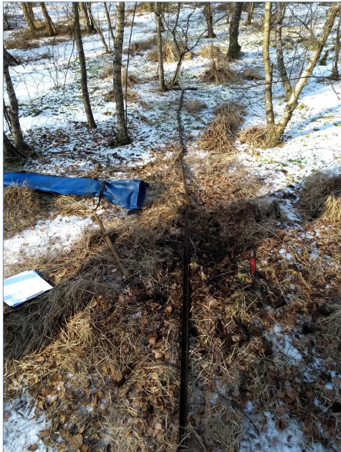
Gutsboring in het Krakenven waarbij aangetoond werd dat er nog een intacte veenlaag aanwezig is van méér dan vijf meter dikte.
