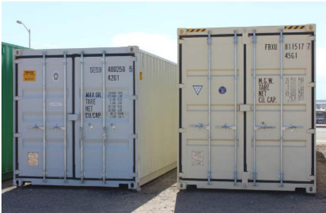
Figuur 4.2 Standaard (links) en high cube – container (rechts)
