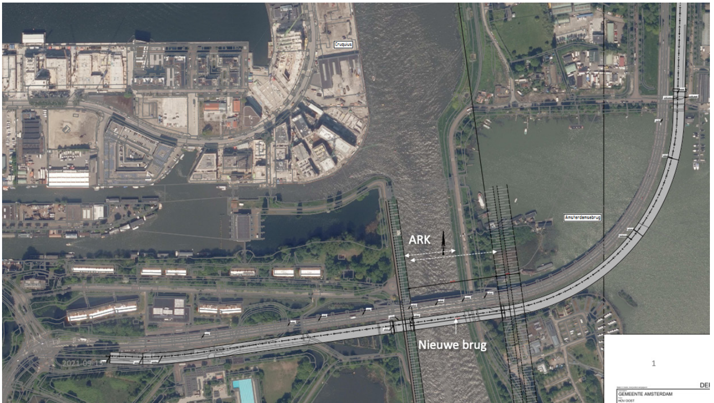
Figuur 4.1 Mogelijk tracé voor een nieuwe brug naast de Amsterdamsebrug. Aan de oostkant van het kanaal is de mogelijke verbreding aangegeven.
