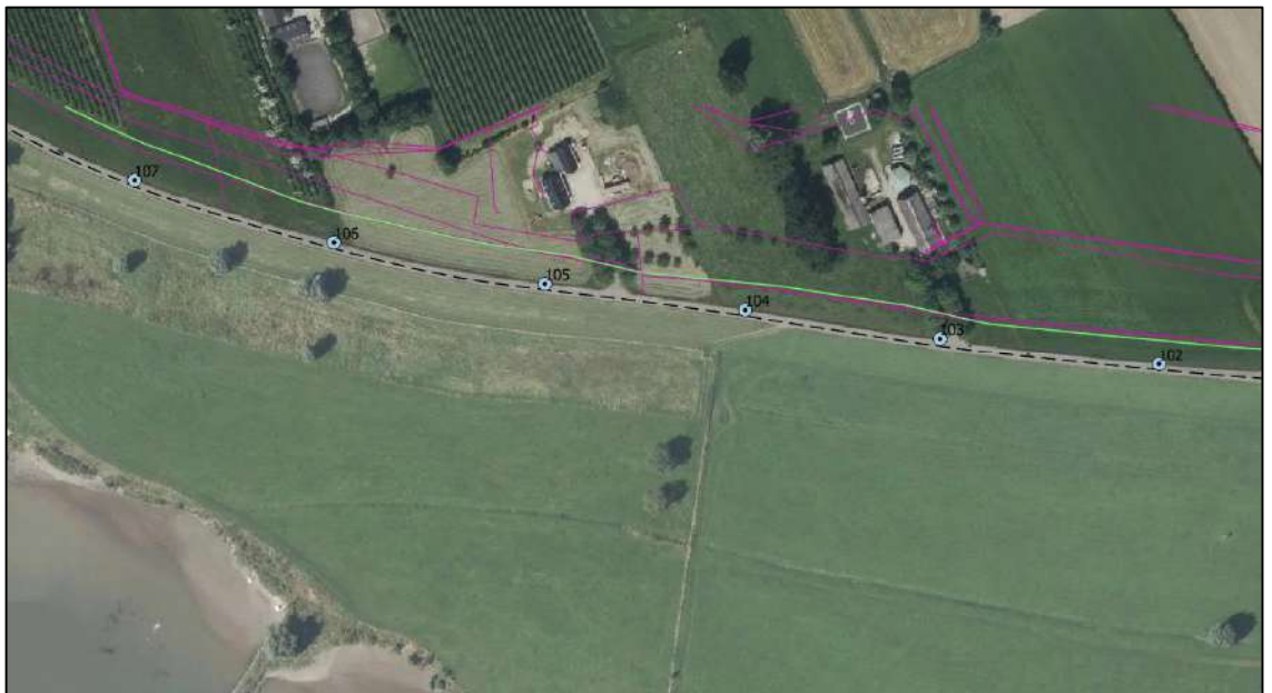
Figuur 23 Raakvlakken tussen kabels en leidingen (paarse lijnen) en het technisch optimale tracé van de verticale innovatieve pipingmaatregel (groene lijn) - dp 102 - dp 107.5
