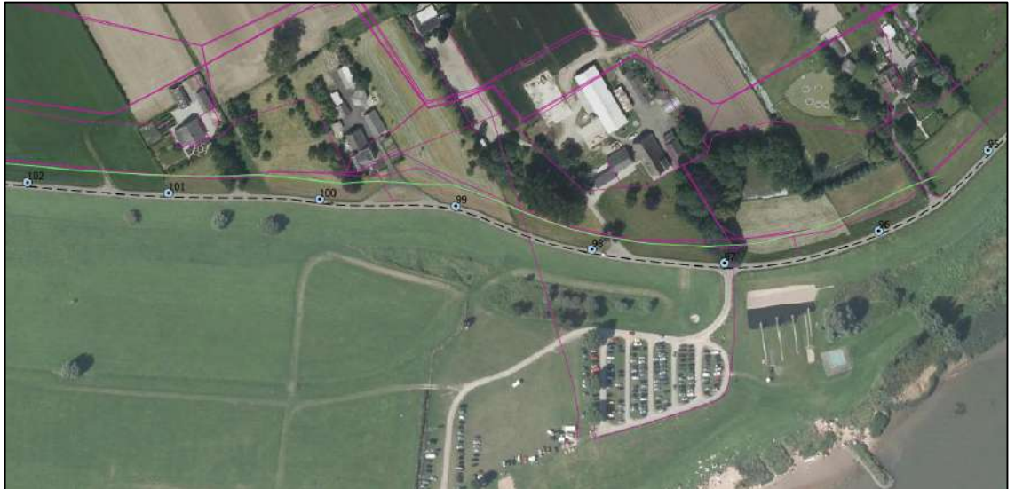
Figuur 22 Raakvlakken tussen kabels en leidingen (paarse lijnen) en het technisch optimale tracé van de verticale innovatieve pipingmaatregel (groene lijn) - dp 95.5 - dp 102
