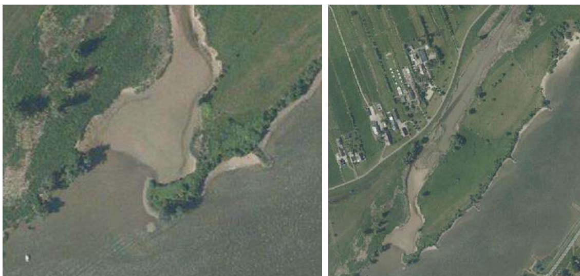
Figuur 10 Referentiesituatie; nevengeul langs de Lek bij km 966. Sedimentatie in de richting van monding van de nevengeul. [3]
