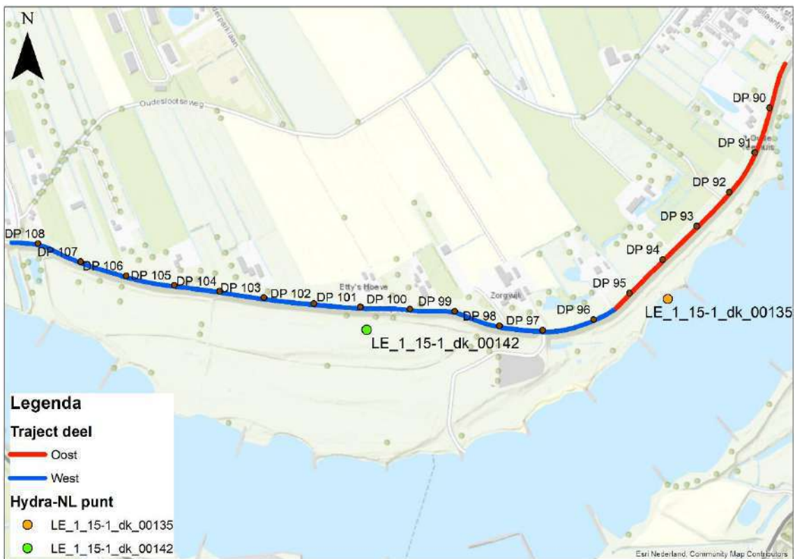
Figuur 8-1: Overzicht van de onderverdeling van het dijktraject t.b.v. de reststerkte-analyse van het buitentalud. Het oostelijke deel (rood) loopt van de oostgrens van het projectgebied tot ca. dijkspaal 95,5 en heeft LE_1_15-1_dk_00135 als representatief Hydra-NL punt. Het westelijke deel (blauw) loopt van ca. dijkspaal 95,5 tot de westgrens van het projectgebied en heeft LE_1_15-1_dk_00142 als representatief Hydra-NL punt.
