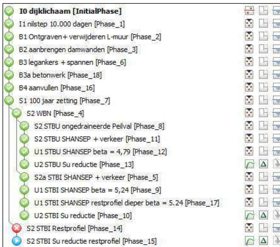
Figuur 13: Rekenschema PLAXIS-berekening kistdam zone 2
