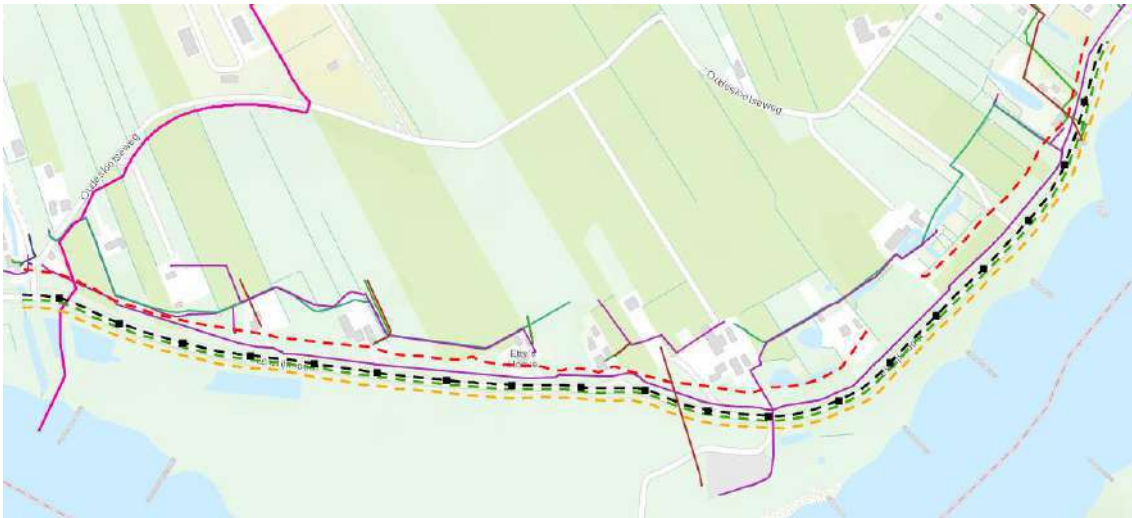
Figuur 10-5: Aanwezige kabels en leidingen in dijktraject Salmsteke
