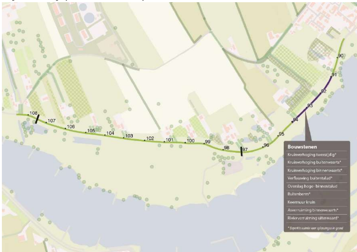
Figuur 16-6: Mogelijke bouwstenen voor het faalmechanisme gras erosie kruin en binnentalud (hoogte)
