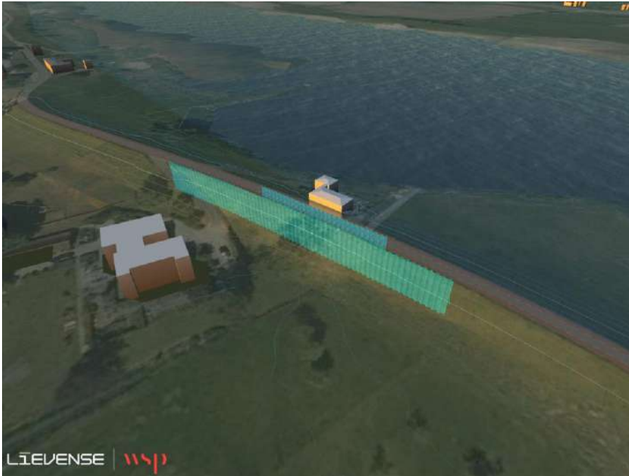
Figuur 6-2: Ruimtelijke inpassing kistdam en damwand
