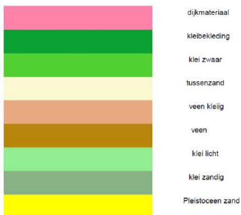
Figuur 1-5 Legenda schematisering bodemopbouw
