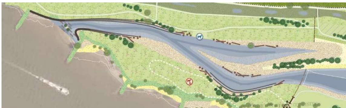
Figuur 2-3: Locaties zandig, steil talud (donkere lijnen langs de oever), en daarom toepassing natuurvriendelijke oeverbescherming
