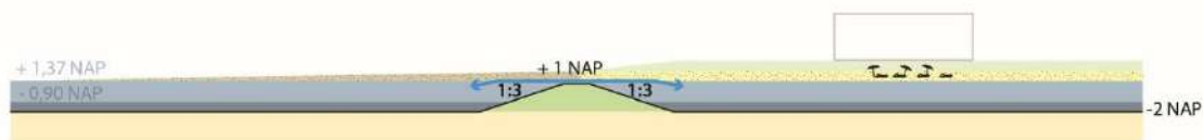
Figuur 2.7: Drempeel tussen getijdengeul (links) en zwemplas (rechts)
