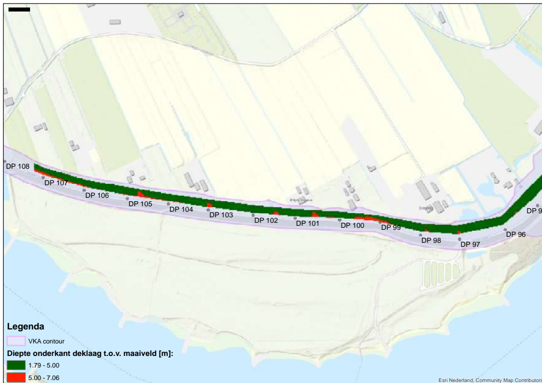
Figuur 11-11: Globale gebied waarin de optimale locatie van het VZG (tussen 1/6 en 1/2 van de totale kwelweglengte gerekend vanaf het uittredepunt). Horizontaal inbrengen van het VZG is mogelijk in de groene gebieden (diepte \leq 5 meter) maar niet in de rode gebieden.
