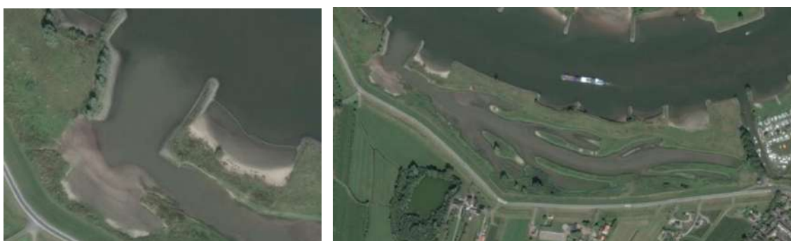
Figuur 11 Referentiesituatie; nevengeul langs de Lek bij km 957. Sterke erosie bij het onbeschermd gedeelte nabij de monding van de nevengeul. [4]
