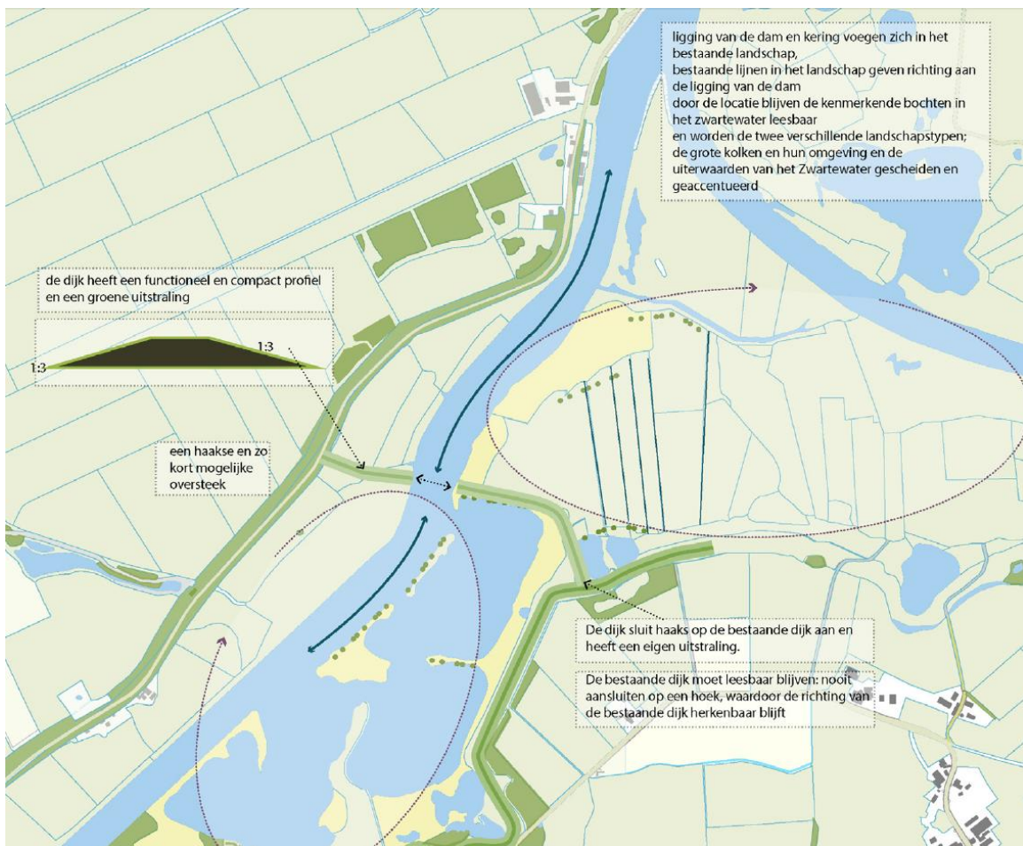
Afbeelding 2.10 Uitgangspunten voor het landschap en de beleving voor de Zwartewaterkering noordzijde (H+N+S, 2017).
