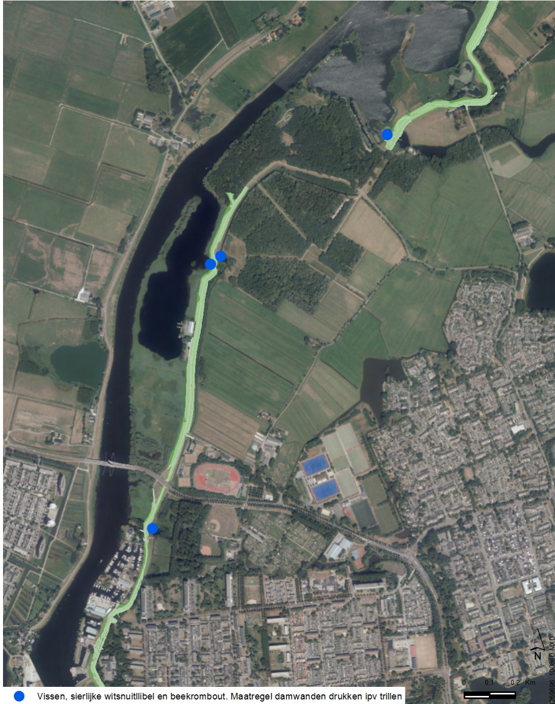
Figuur 4.1 Locaties waar damwanden worden gedrukt in plaats van getrild omdat deze nabij een oever worden geplaatst.
