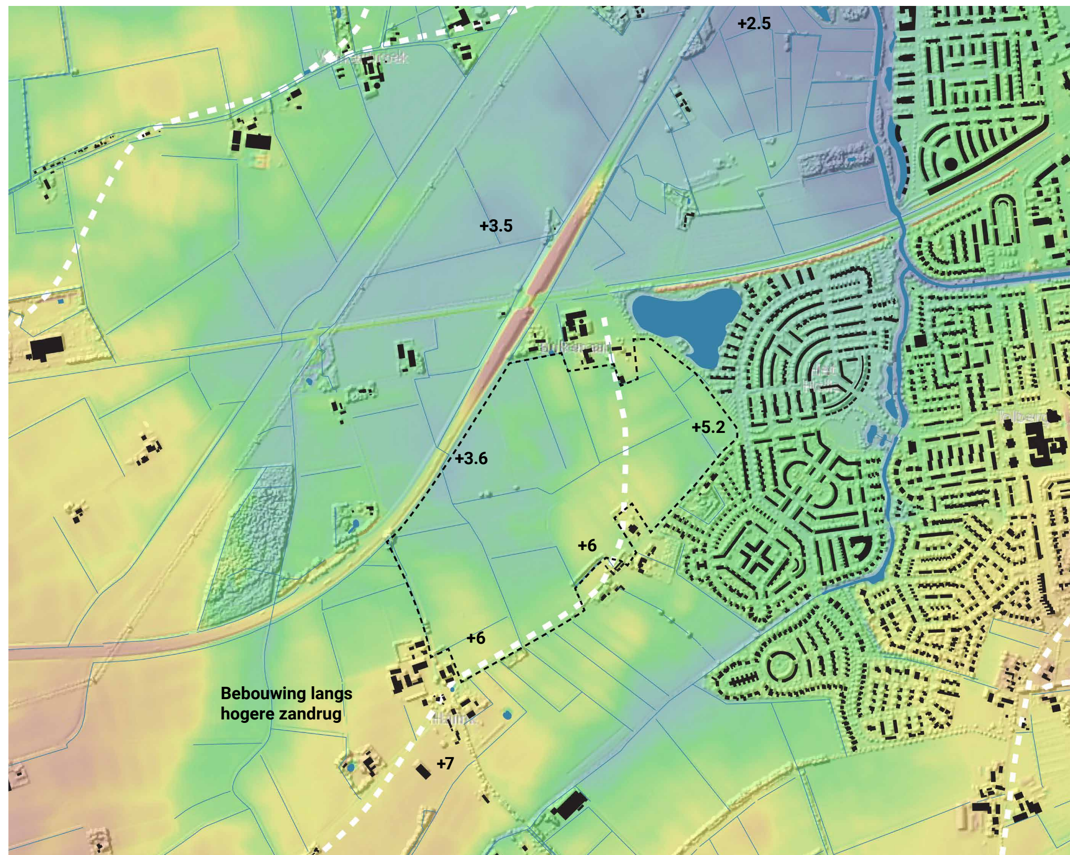
Hoogte versus occupatie: Een dekzandrug loopt schuin door het plangebied van De Bulkenaar. Deze verklaart waar de meeste historische/agrarische cultuurlandschappelijke bebouwing geplaatst is.
