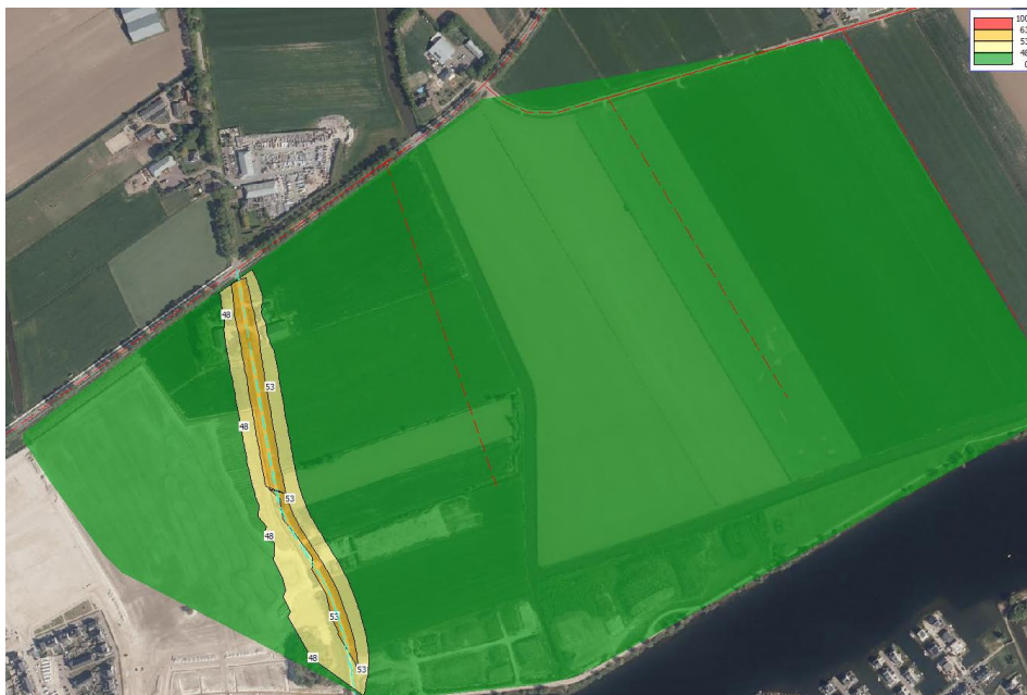
Figuur 7.6 | Geluidbelasting vanwege de Rosmalensedijk
