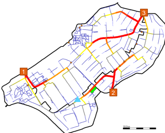
Figuur A.1. Modelschematisatie van het netwerk van vaarten in Flevoland voor de modellering van de temperatuur in de Hoge Vaart. 1, 2, 3: belangrijkste gemalen. Kleuren geel-rood: indicatie van onttrekkingsgebied per gemaal. Blauwe driehoek: meetpunt watertemperatuur Adelaarsweg. Groen vlak: onderzoeksgebied (Trekkersveld IV en Campus Datacenter).
