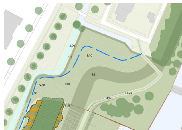
Optie 1. Behoud talud "verblijfsplek sluis" en verleggen talud wadi
