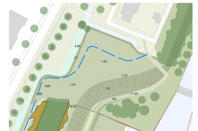
Optie 3. verleggen taluds langs wadi en kruin
