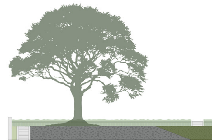
Coupure Bellevue noord: talud doorzetten (oost) + extra vleugelwand ca 1:1,4 (west) voor opvangen talud binnendijks om damwand te verhullen
