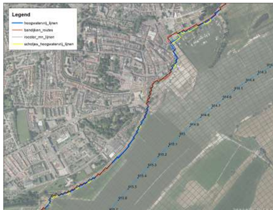
Figuur 3 Extra "ondoorlatende schotjes" (geel) zoals opgenomen in WAQUA om de dijkversterking te representeren.
