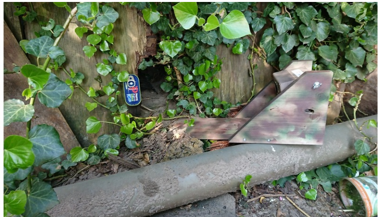
Afbeelding 3: Weergave van de close-range opstelling ontwikkeld door Breur Ecologie & Onderzoek. Een simpele opstelling welke op veel manier te gebruiken is. Door vleugelmoeren in de hoekpunten van de camerabehuizing is de optimale beeldhoek in te stellen. Voorzetlensjes variërend in sterkte worden op basis van de verwachte detectieafstand voor de cameralens geplaatst. Het plankje voor de camera voorkomt obstructie van het beeld door plantengroei. Rechts de close-range opstelling op locatie 7, gericht op een veel belopen doorgang langs een vervallen schuurtje, deze cameraopstelling is na de foto verder toegedekt met gebiedseigen materiaal, ter camouflage en om de dieren nog beter langs de camera te leiden.
