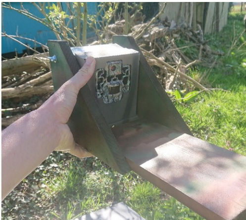
Afbeelding 3: Weergave van de close-range opstelling ontwikkeld door Breur Ecologie & Onderzoek. Een simpele opstelling welke op veel manier te gebruiken is. Door vleugelmoeren in de hoekpunten van de camerabehuizing is de optimale beeldhoek in te stellen. Voorzetlensjes variërend in sterkte worden op basis van de verwachte detectieafstand voor de cameralens geplaatst. Het plankje voor de camera voorkomt obstructie van het beeld door plantengroei. Rechts de close-range opstelling op locatie 7, gericht op een veel belopen doorgang langs een vervallen schuurtje, deze cameraopstelling is na de foto verder toegedekt met gebiedseigen materiaal, ter camouflage en om de dieren nog beter langs de camera te leiden.
