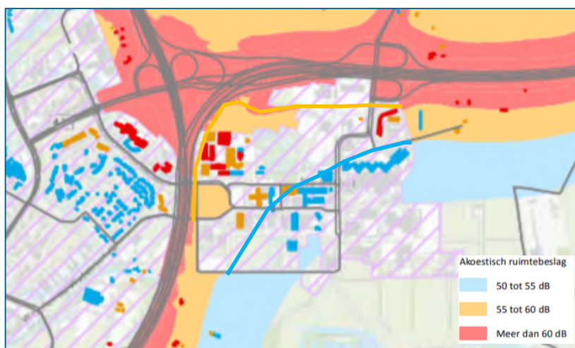
Figuur 6-3: Geluidbelasting snelwegen in plansituatie (Bron: Ontwerp-Tracébesluit 2020).
