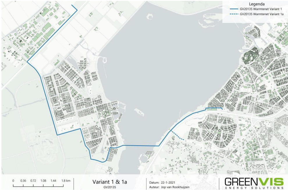
Figuur 3-1 Tracé warmtebuisleiding langs de zuidelijke route via Zeewolde. Variant 1 en 1a.
