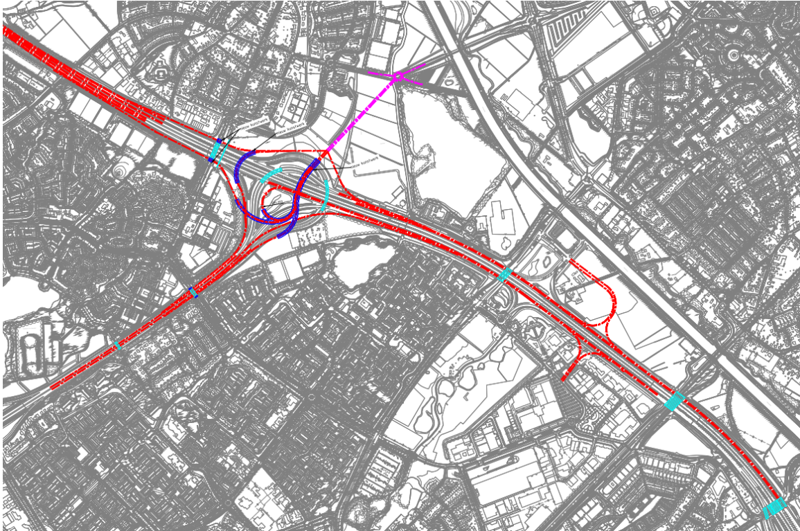
Afbeelding 4.46 Volledige aansluiting in knooppunt Empel
