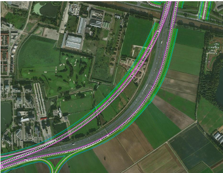
Afbeelding 5.28 Ontwerp weefvak in boog tussen einde parallelstructuur Li en afrit Sint-Michielsgestel
