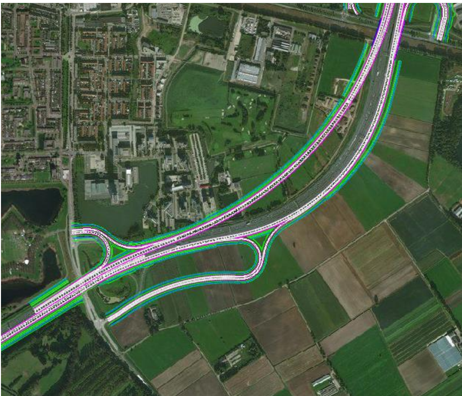
Afbeelding 5.44 Ontwerp aansluiting Sint-Michielsgestel en wegvak Veghel - Sint-Michielsgestel
