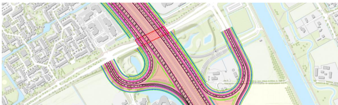
Afbeelding 6.54 Aansluiting Rosmalen Re raakt bestaande bebouwing en sluit niet aan op bestaand OWN
