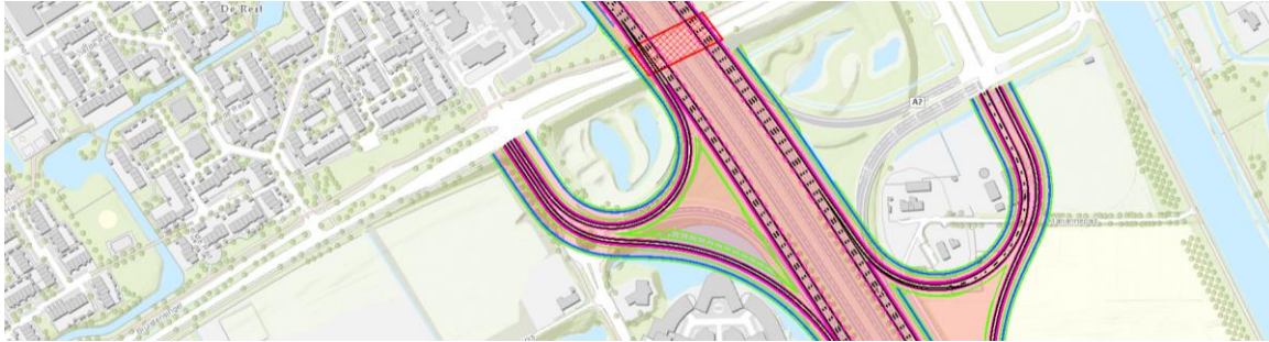
Afbeelding 6.12 Aansluiting Rosmalen Re raakt bestaande bebouwing en sluit niet aan op bestaand OVN
