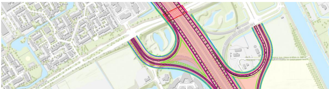
Afbeelding 6.33 Aansluiting Rosmalen Re raakt bestaande bebouwing en sluit niet aan op bestaand OWN
