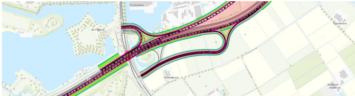
Afbeelding 6.40 Toerit aansluiting Sint-Michielsgestel Li bevat onverwachte krappe boog
