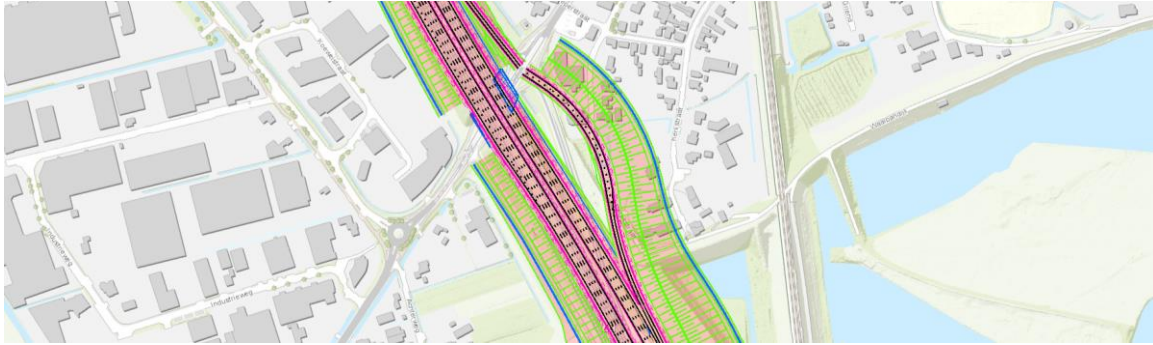
Afbeelding 6.25 Aansluiting Waardenburg Li raakt bestaande bebouwing
