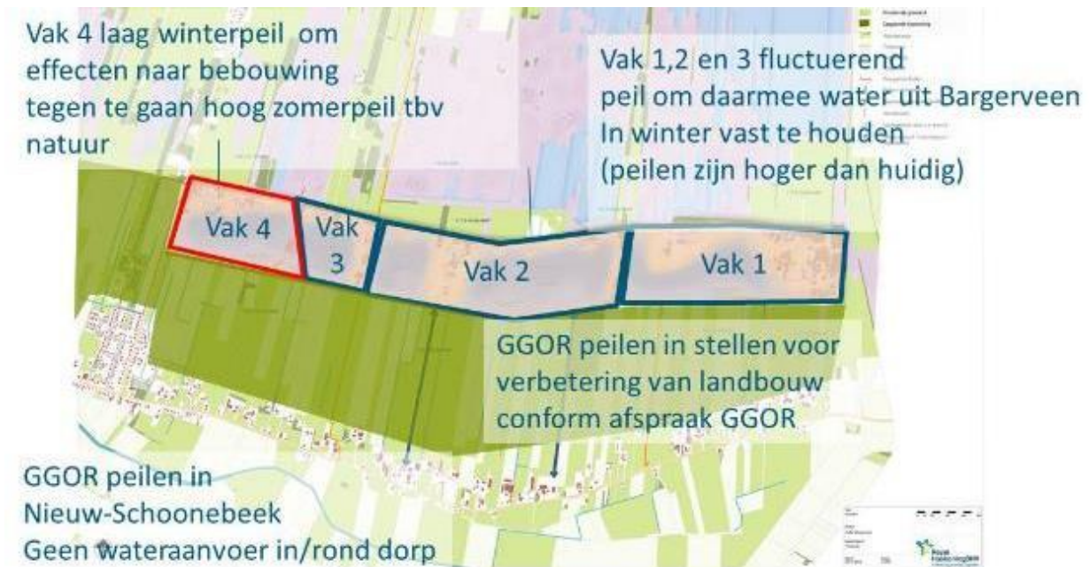
Figuur 16. Principe-inrichting peilverdeling
