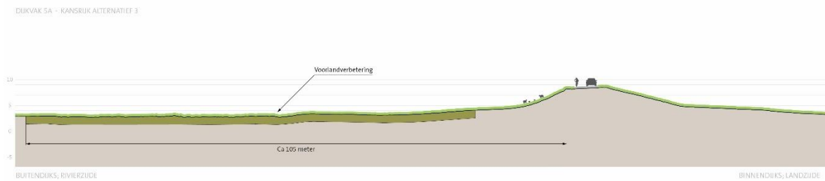
Afbeelding 6 Schematisch dwarsprofiel voorlandverbetering. Bron: RHDHV.
