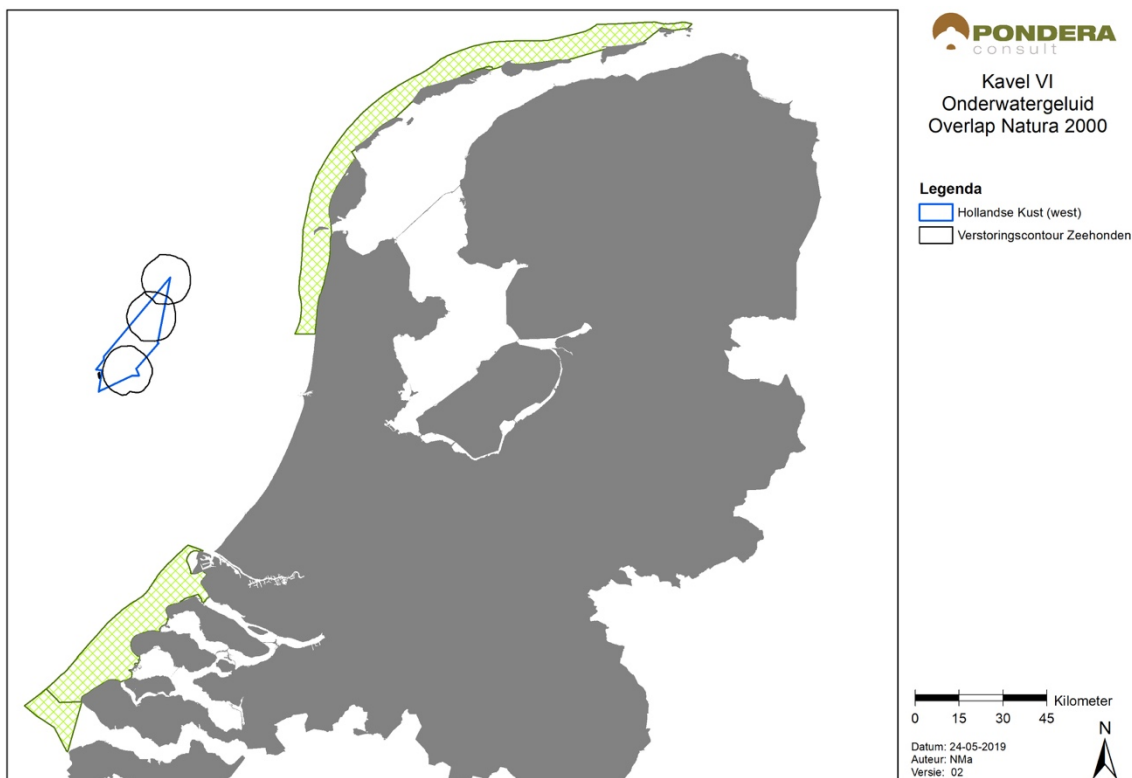
Figuur 3-3 Verstoringcontouren van zeehonden in relatie tot het Natura 2000-gebied Noordzeekustzone door heien voor de aanleg van van kavel VI (beide verkavelingsalternatieven) van windenergiegebied Hollandse Kust (west).
