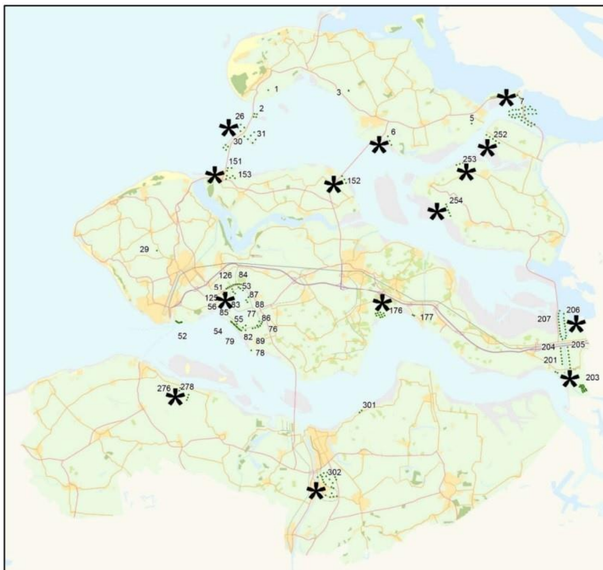
Kaart 11: Concentratielocaties windenergie en bestaande windturbines.
