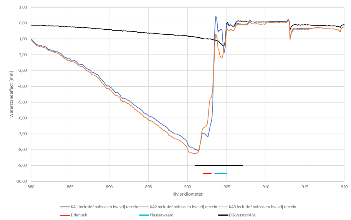
Figuur 4-6 Waterstandseffect alternatieven inclusief oobos en verwijderen hoogwaterrijn terrein
