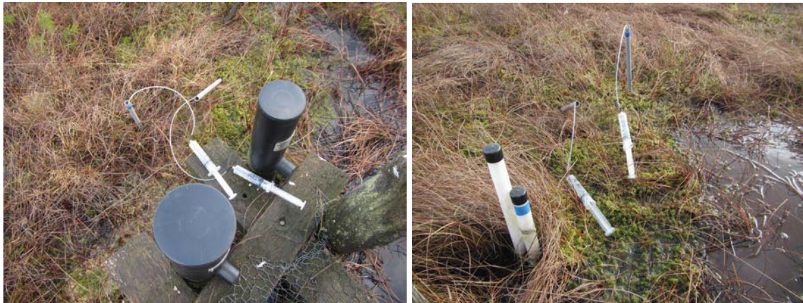
Figuur 14. Foto van peilbuis B141 (links) en tpb139 (rechts). Foto's: Mark van Mullekom.
