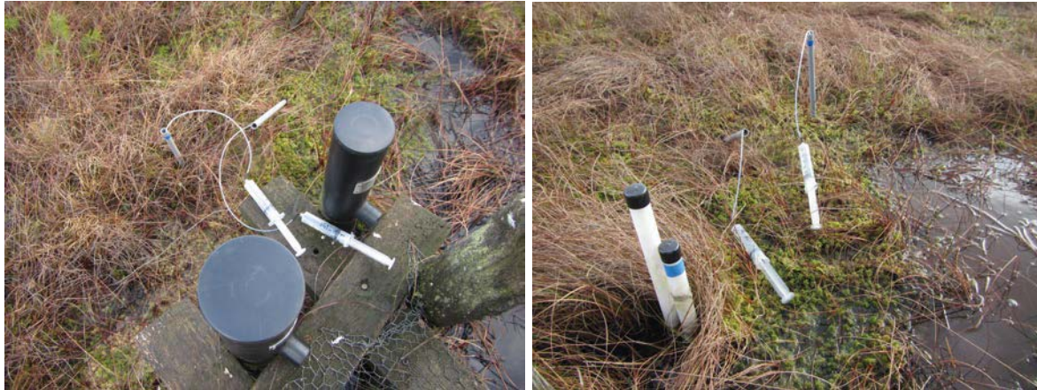
Figuur 14. Foto van peilbuis B141 (links) en tpb139 (rechts). Foto's: Mark van Mullekom.
