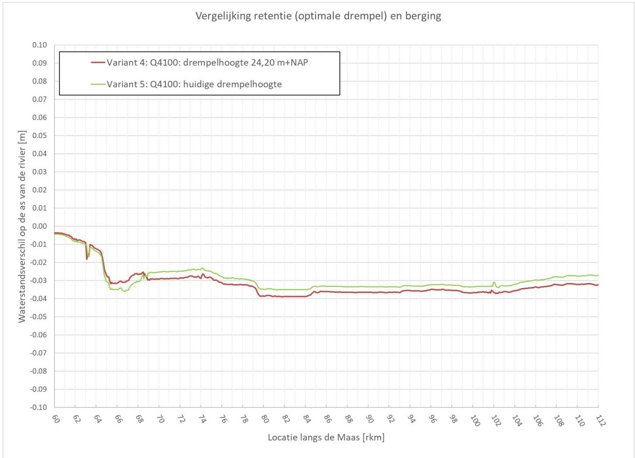
Figuur 10: Waterstandseffect van variant 5 op de as van de rivier bij T300 (Q 4.100 m 3 /s) in het zichtjaar 2075. De waterstand van variant 4 (met optimale drempel) is voor het vergelijken ook in deze grafiek gezet
