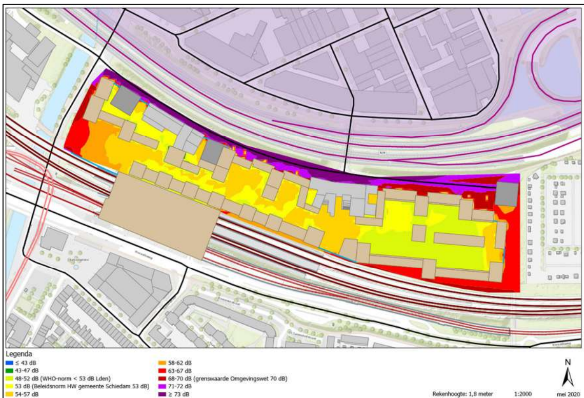
Afbeelding 111 Gecumuleerde geluidscontouren (hoogte 1,8 meter) Lvl,cum - met bestaande stationskap
